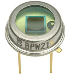
Dans le sens bloquant, la photodiode se comporte comme un interrupteur ouvert, donc la tension à ses bornes est de 3,3 V. Mais lorsqu'elle est suffisamment éclairée, elle laisse passer du courant. Plus elle est éclairée, plus l'intensité du courant augmente.
